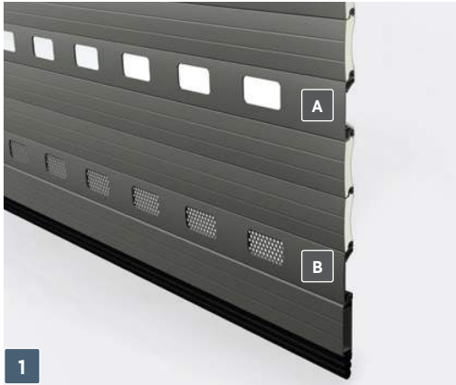
1 Portens gardin – tillverkad av aluminiumprofiler (höjd: 100 mm och tjocklek: 25 mm) fyllda med freonfritt polyuretanskum. (A) – enkelväggig aluminiumprofil (med glas) (B) – enkelväggig aluminiumprofil (ventilerad).
