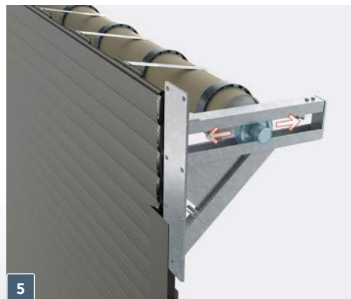
5 Rörlig axel – när den rörliga axeln lindar upp gardinen ändrar den sin position i förhållande till överstyckets vägg för att säkerställa att skenorna är i linje.
